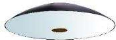
Luminario Decorativo para suspender modelo ZÄNA, Fabricado en lamina de acero rolada en frio con acabado en poliéster de aplicación electrostática negro / blanco. Difusor de acrílico opalino, cable para suspender 1.2m. Sistema LED on/off.
